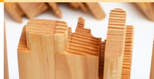
Stirnseitig nahezu ausrissfrei durch Leitz RipTec-Verfahren
