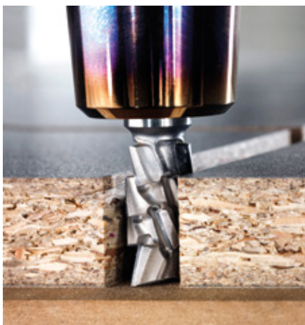
Diamaster PRO 3 (links) – die erste Wahl zum Formatieren auf Nestingmaschinen und Losgröße 1-Anlagen. Diamaster PLUS 3 (rechts) – der Hochleistungsfräser für Formatbearbeitungen im industriellen Einsatz.
