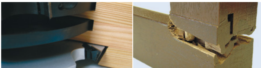
Uiterst dichte voeg aan de borsten en de hoogste stijfheid van de verbinding
