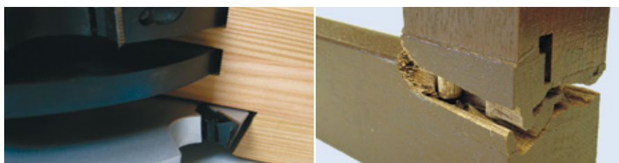
Těsné, tvarové velmi přesné rohové spojení s vysokou pevností
