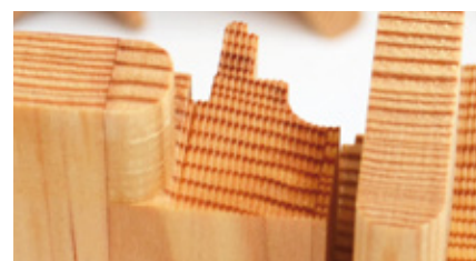
Typický povrch s RipTec-em při příčném frézování, bez vyštipané výběhové hrany
