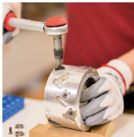
Die Schneiden können beim Werkzeugsystem Diamaster WhisperCut wahlweise im Leitz Service instand gesetzt oder vom Anwender vor Ort ausgetauscht werden.
