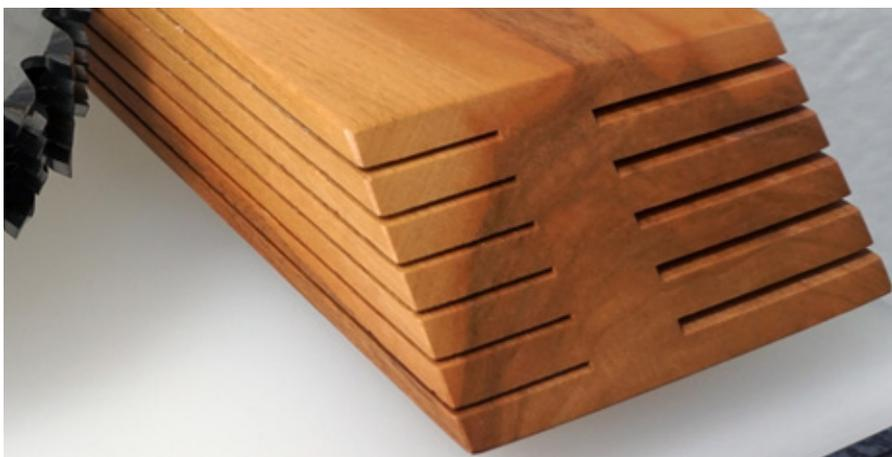
Durch den Einsatz von Leitz Dünnschnittkreissägeblättern können beispielsweise 7 anstatt 6 Lamellen produziert werden. Dies bedeutet eine Produktivitätssteigerung von ca. 17 %.
