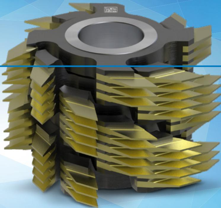
**Die Festigkeit von Keilzinkenverbindungen wird von vielen Faktoren, wie beispielsweise Werkzeug, Maschine, Kleber oder Werkstoff beeinflusst. Daher ist es wichtig all diese Faktoren aufeinander abzustimmen. Nur so können exakt passende Keilzinkenverbindungen prozesssicher produziert werden.**
