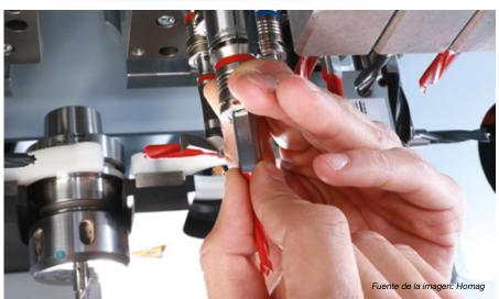
En los centros de mecanizado CNC o mediante máquinas de alimentación, el cambio de herramientas suele ser una tarea que requiere mucho tiempo. Como consecuencia, las estaciones de perforación a menudo se convierten en un cuello de botella de producción debido a los tiempos de inactividad resultantes.
