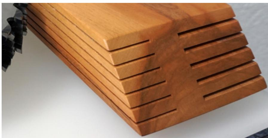
Grâce aux lames de scie fines Leitz, on peut à titre d'exemple produire 7 lamelles au lieu de 6. Cela correspond à une augmentation de la productivité d'environ 17 %.
