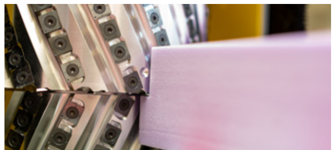
Exemples d'usinage de matériaux d'isolation – CentroFix (photo de gauche) pour le calibrage de l'épaisseur et HeliCut (photo de droite) pour l'usinage latéral.
