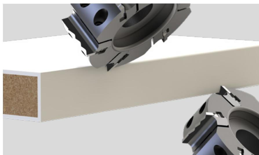
**L'utilisation d'outils diamantés est indispensable dans la finition des chants, mais peut également s'avérer coûteuse. Le réaffûtage pourrait réduire les coûts, mais chaque affûtage entraîne des ajustements de la machine qui prennent du temps en raison des changements de diamètre de l'outil. Résultat : pas d'économies réelles, mais des temps d'arrêt inutiles.**
