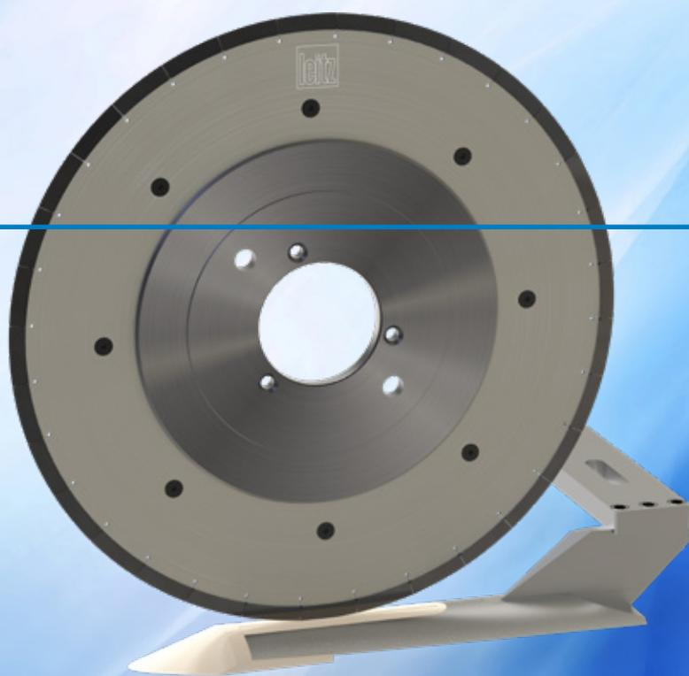
**Nella produzione di pannelli in fibrocemento i coltelli circolari in metallo duro per il taglio dei pannelli grezzi si usurano in modo particolarmente rapido. Le conseguenze sono l'arresto della linea di produzione e il cambio utensile che richiede tempo.**
