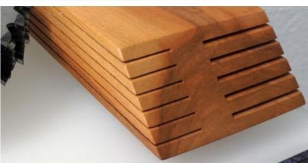
Utilizzando lame Leitz per taglio sottile, ad esempio, è possibile produrre 7 lamelle anzichè 6. Questo significa un incremento della produttività di ca. il 17%.
