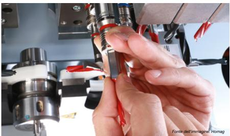
Sui centri di lavoro CNC o sulle macchine a ciclo continuo, il cambio della punta è di solito un compito che richiede tempo. Di conseguenza, nelle stazioni di foratura si crea spesso un ostacolo alla produzione a causa dei tempi di inattività che ne derivano.
