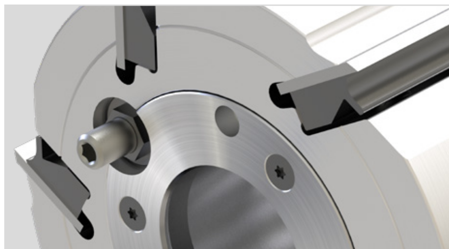
Pistone assiale di azionamento per l'aumento della pressione
