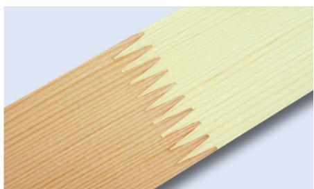
フィンガージョイントの強度は、工具、機械、 接着剤、加工材など多くの要因に左右されます。 したがって、これらすべての要因を 調整することが重要です。こうしてはじめて 正確にかみ合うフィンガーを確実に製造することができます。
