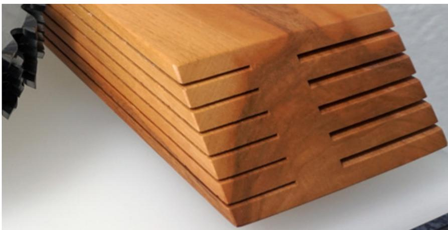
ライツ薄刃チップソーを使用する事で、刃幅が薄く廃棄が少ない。例えば、6枚の小割の代わりに7枚の小割加工ができます。これは、生産性が約17%向上することを意味します。
