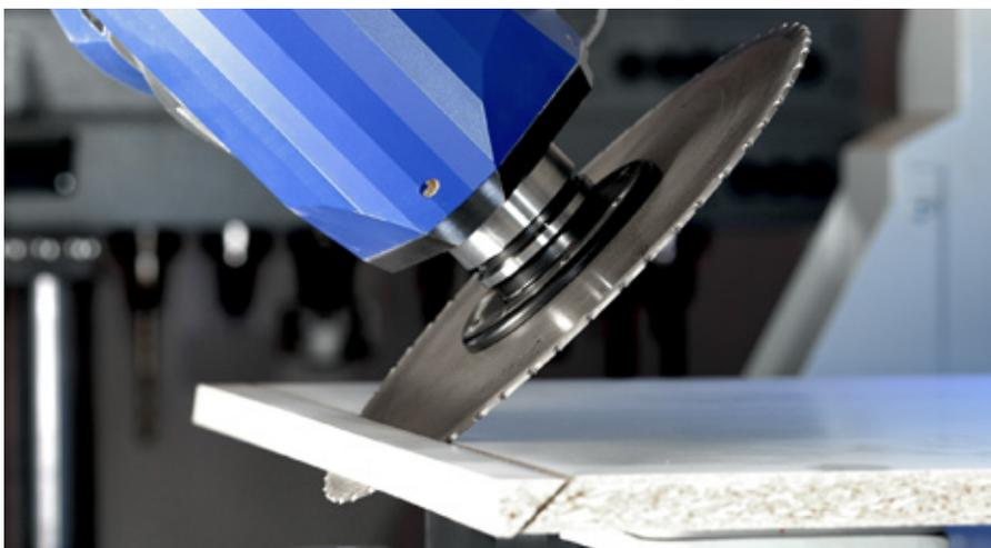
ウィスパーカットチップソーは、従来のすべての材料で完璧なマイターカット（留め切り）を提供します。
