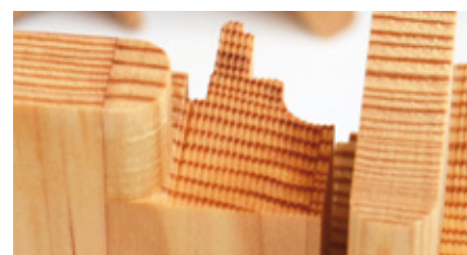
Typowa powierzchnia z RipTec przy obróbce poprzecznej – czopowaniu
