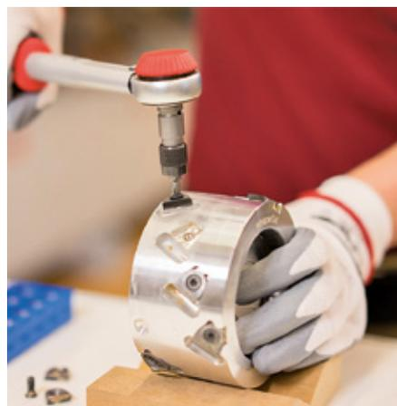
Com o sistema de ferramentas Diamaster WhisperCut, as pastilhas de corte podem ser reparadas pelos postos de serviço Leitz ou substituídas pelo cliente no local.
