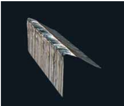
Scharfkantiger Verschleiß an einer beschichteten HS-Schneide
