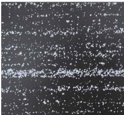
Zeilenförmiges Gefüge bei schmelztechnisch hergestelltem HS-Stahl
