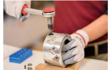
WhisperCut: Diamant-Schneiden bis zu 3x nachschärfbar
