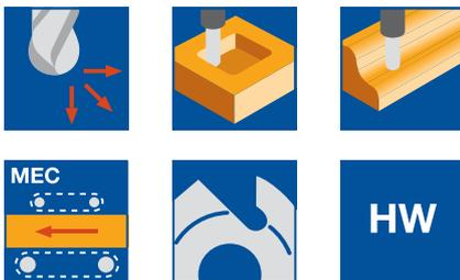
**HW-massiv, Z 2, mit Radius, polierte Spannutt**
