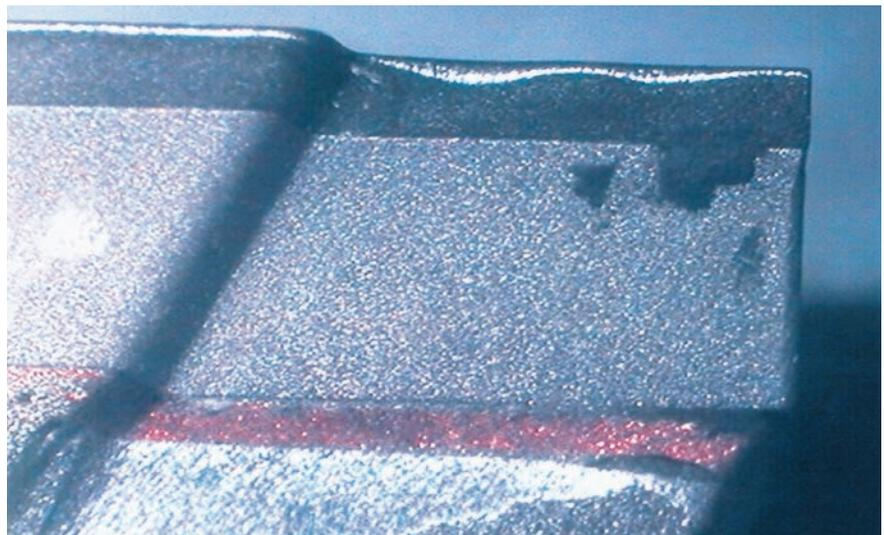
Schneidkantenverrundung nach Einsatz in GFK.
