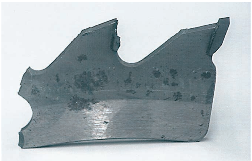
Zerstörung des Sägezahnes durch Überbelastung.
