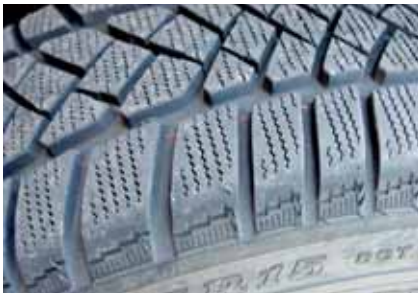
Reifenprofil mit Ungleichteilung.
