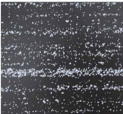
Zeilenförmiges Gefüge bei schmelztechnisch hergestelltem HS-Stahl
