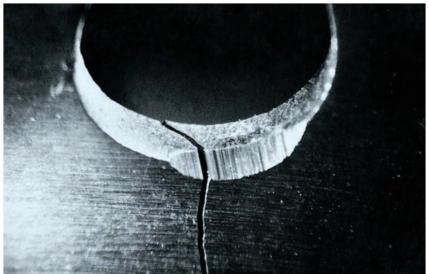
Einriss am Tragkörper.
