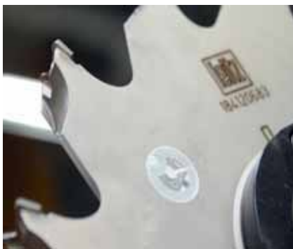
Werkzeug mit NFC Chip
