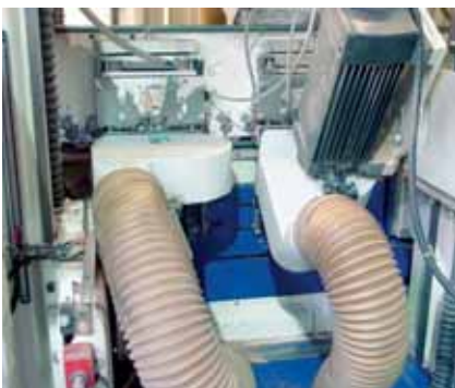
Problem: Maschinenverschleiß durch abrasive Späne.
