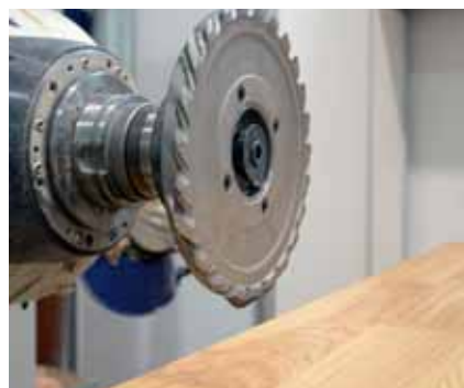
DFC®-Werkzeug für gerichteten Spänestrahl. DFC®-System: Werkzeug mit angepasster Absaughaube. Der größte Teil der Späne wird erfasst und der Verschleiß von der Maschine ferngehalten.
