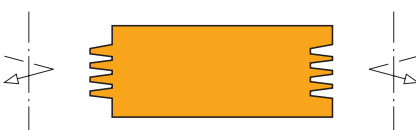
Profil 3 mit Randzinken auf gleicher Ebene
