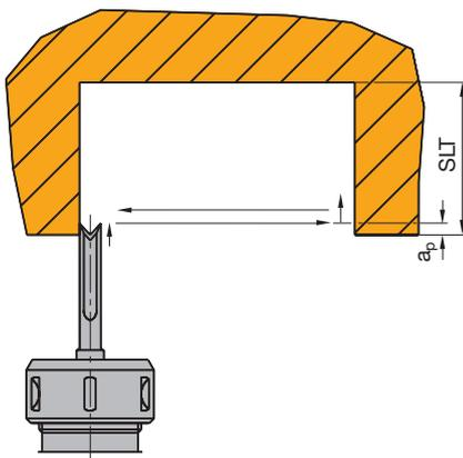
Exemple d'application: réalisation d'une mortaise
