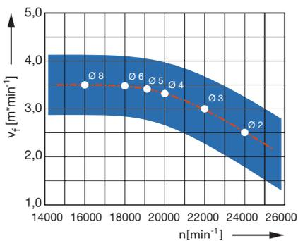
**Vitesse de rotation:**  $n = 16000 - 24000 \text{ min}^{-1}$   $v_f = 2,5 - 3,4 \text{ m min}^{-1}$
