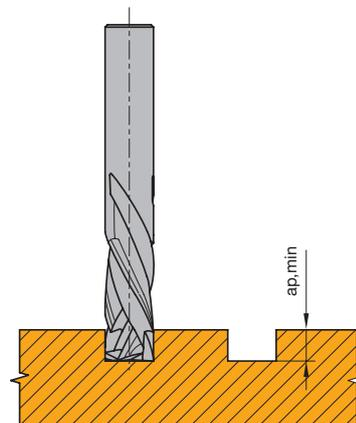
Profondeur minimale de rainure  $a_{p \text{ min}}$  pour coupe sans éclats
