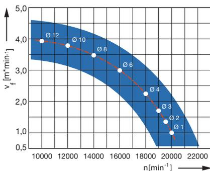
**Vitesse de rotation:**  $n = 8000 - 24000 \text{ min}^{-1}$   $v_f = 1,0 - 4,0 \text{ m min}^{-1}$
