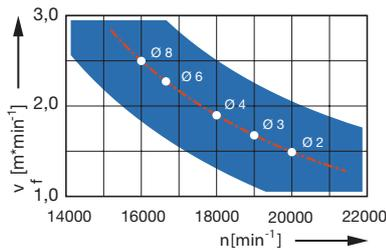
**Vitesse de rotation:**  $n = 16000 - 22000 \text{ min}^{-1}$   $v_f = 2,0 - 2,5 \text{ m min}^{-1}$
