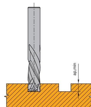
Profondeur minimale de rainure a<sub>p min</sub> pour coupe sans éclats
