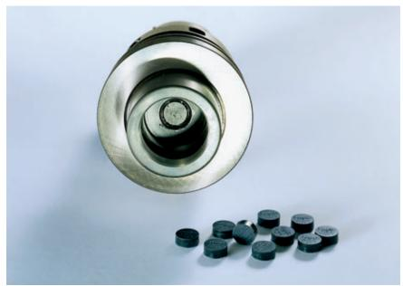
Une puce électronique, sur laquelle on aura inscrit toutes les informations de géométrie et de sécurité etc., propre à l'outil, est placée dans l'outil ou dans l'interface de l'outil. Sans contact mécanique, ces données sont identifiées et validées par le centre d'usinage. Cette technique permet non seulement de réduire les temps de réglage, mais également d'améliorer la sécurité du travail.
