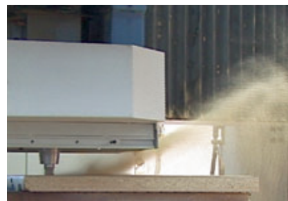
Mèche à défoncer DFC®. Le flux de copeaux est dirigé vers le haut en direction de l'aspiration.
