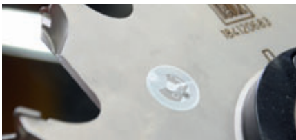
Outil avec support de données intégré.
