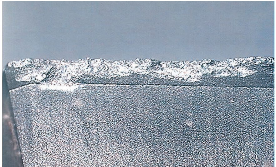
Uitgebroken diamant (DP) snijkant.
