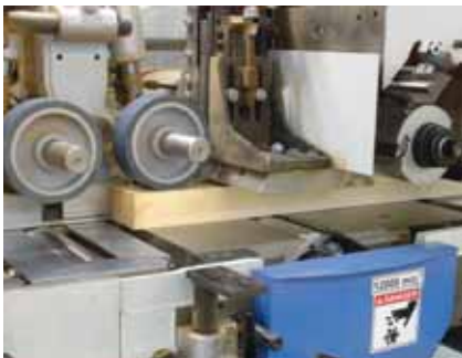
Detail aanzicht van een vierzijdige- en profileermachine met aanvoerrollen
