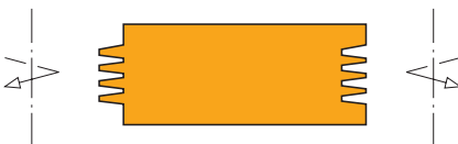
Profiel 3 met randvingerlassen op gelijke hoogte
