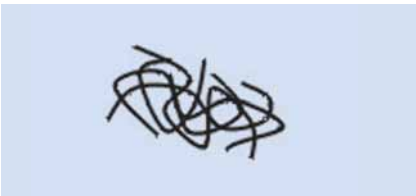
Vezelvorming van polymeren bij thermoplasten (principe weergave)
