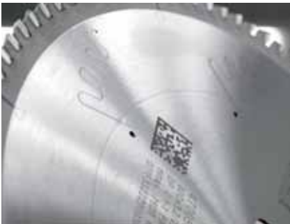
Gereedschap met DataMatrix Code
