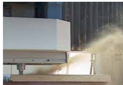
DFC®-bovenfrees: spanenstraal wordt naar boven richting de afzuiging weggeleid en kan afgezogen worden.
