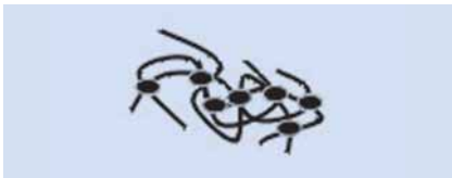
Structuur van duroplasten (principe weergave)
