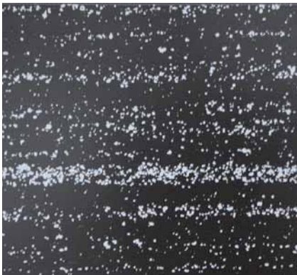
Lijnvormige structuur bij smelttechnisch geproduceerd HS-staal
