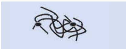
Structuur van elastomeren (principe weergave)
