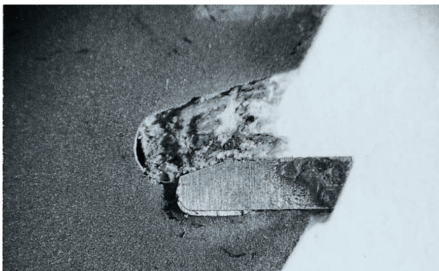
Snijkant beschadiging door verkeerd gebruik.
