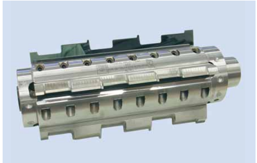
Gereedschap voorbeeld voor gebruik van PKS®: meervoudige profilering van MDF-lijsten
