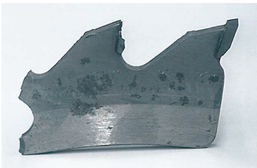
Beschadiging van de zaagtand door overbelasting.
