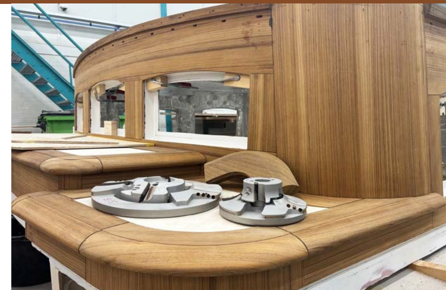
Gebogen houten constructie in een jachtinterieur vraagt om nauwkeurige profilering en speciaal gereedschap.
