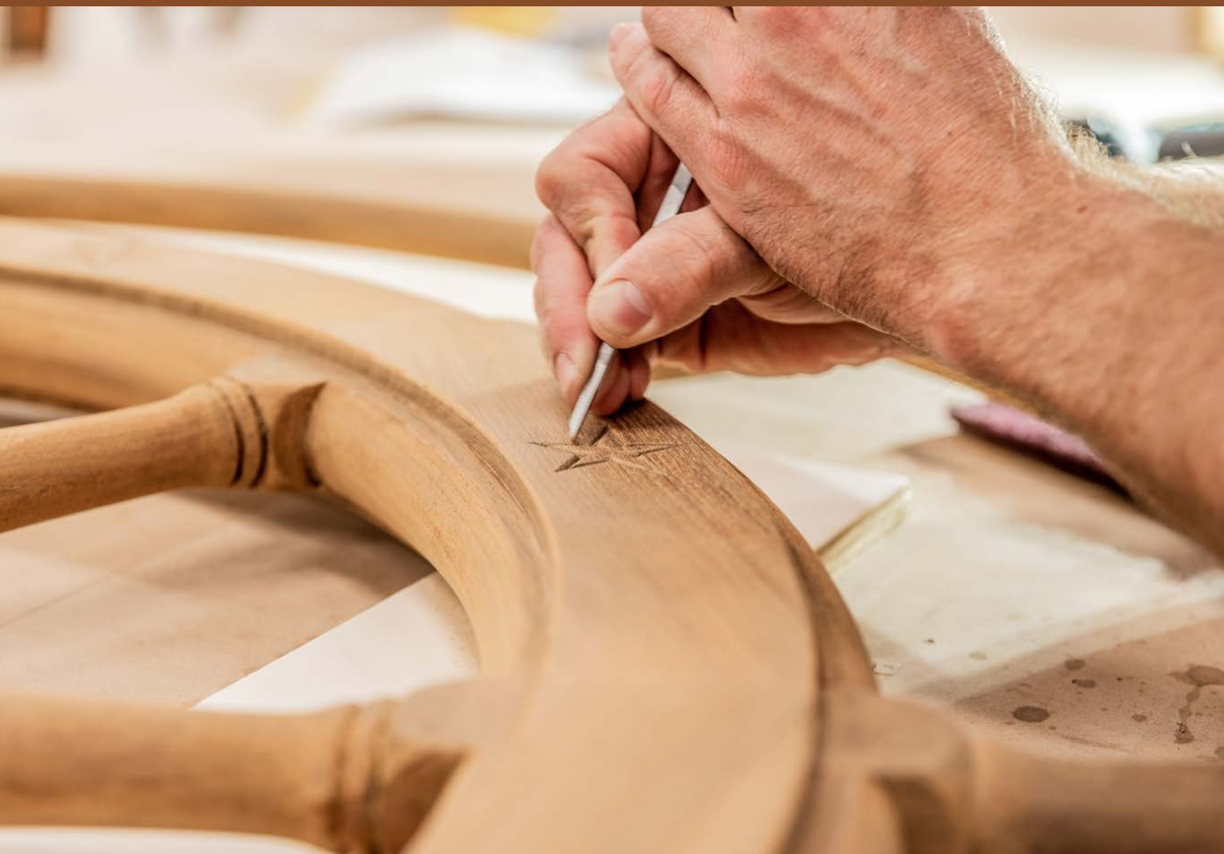
Handmatige nabewerking van een houten profielonderdeel in de jachtbetimmering.
